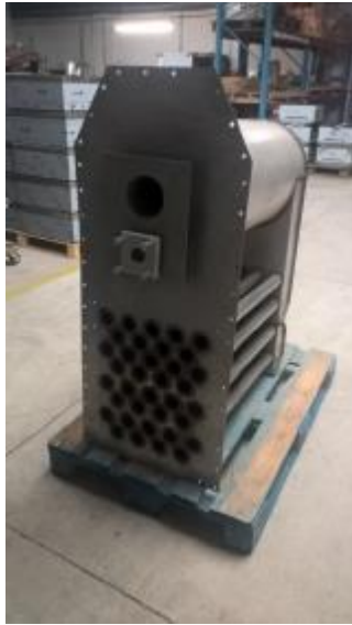
8.2.3 ábra: Elektromos hőcserélő (21)
