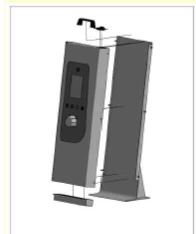
8.2.6 ábra: Vezérlő és kijelző (robbantott terv) (49)
