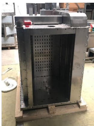
7. ábra: Ferrara Forni FLEX összecsavazott, burkolat nélküli állapota (13, 14)
