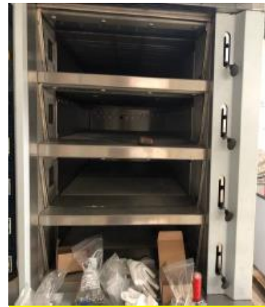
8.2.5 ábra: Gázos hőcserélős sütő külső szerkezete burkolva szemből (aknák) (43)
