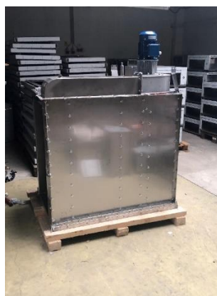
7. ábra: Ferrara Forni FLEX összecsavazott, burkolat nélküli állapota (13, 14)
