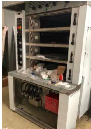
8.2.5 ábra: Gázos hőcserélős sütő külső szerkezete burkolva, elől nyitott (42)
